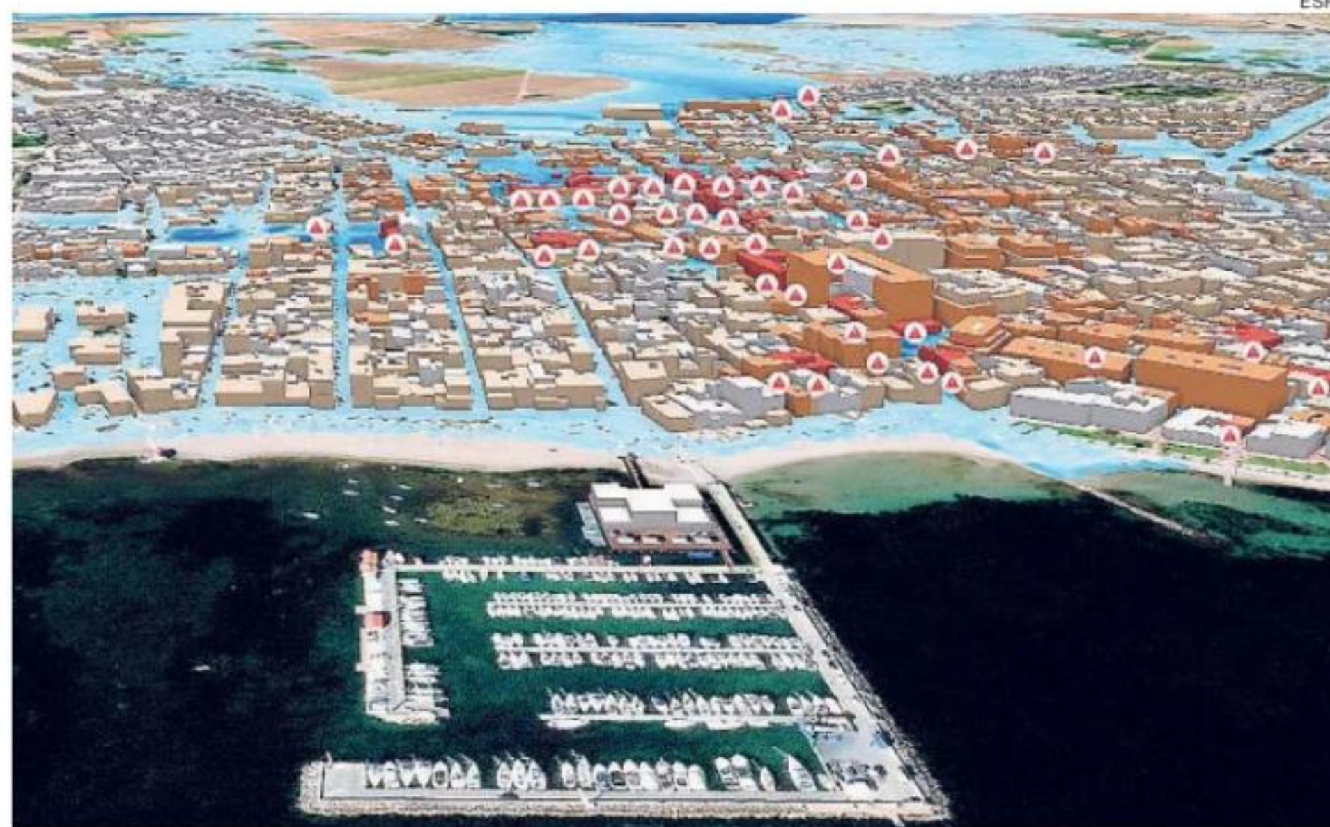
Simulación de inundaciones en el Mar Menor usando datos del catastro y cartografía de riesgos fluviales
